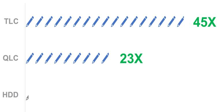
**Abbildung 4: Vergleich von GB geschrieben auf Basis eines Schreiblastprofils von 10 %**
